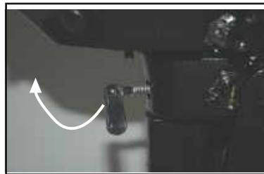
2. Drehen Sie den Hebel zur Einstellung des Lenkwiderstandes fest, im Uhrzeigersinn, um zu verhindern, dass dieser sich frei dreht.
