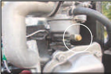
4. Befüllen Sie Motor mit frischem Motoröl
